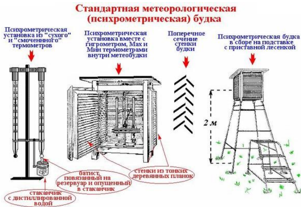
Рис. 3. Психрометрическая будка (общий вид)
