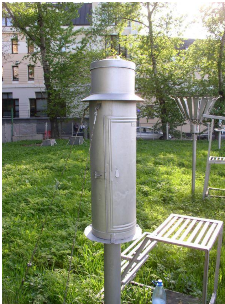
Рис. 16. Плувиограф (передний план), осадкомер Третьякова (задний план)
